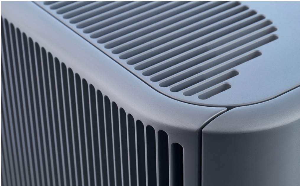
Die Gehäuseteile wurden aus Alublöcken herausgearbeitet. Es dauert beispielsweise acht Stunden bis aus einem 23-Kilo-Quader ein Kühlkörper entsteht
