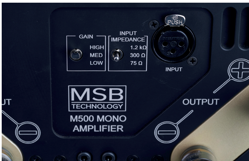
Mit diesen Schaltern lassen sich die Verstärkung und die Eingangsimpedanz wählen, Vorsicht: Nicht alle Vorstufen dürften mit 75 oder 300 Ohm gut zurecht kommen. Wählen Sie zum Einstieg 1,2 Kiloohm
