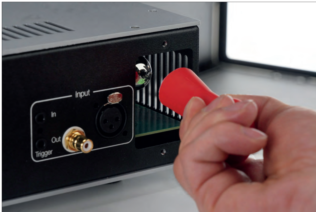
Hinter der Serviceklappe verbirgt sich die Doppeltriode, die man für eigene klangliche Experimente auch austauschen kann
