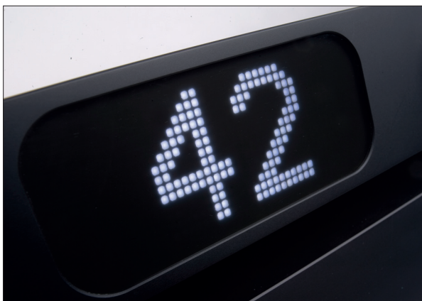
Sowohl das kontrastreiche Display als auch die vier Prime-DAC-Blöcke werden intern von derselben Clock getaktet, um Beeinflussungen zu vermeiden
