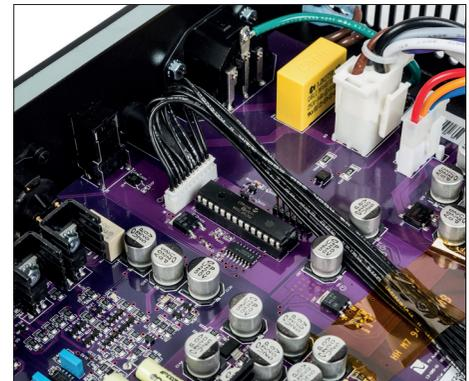
Ausgerechnet der steuernde Mikrocontroller ist noch ein klassisch bedrahtetes Bauteil
