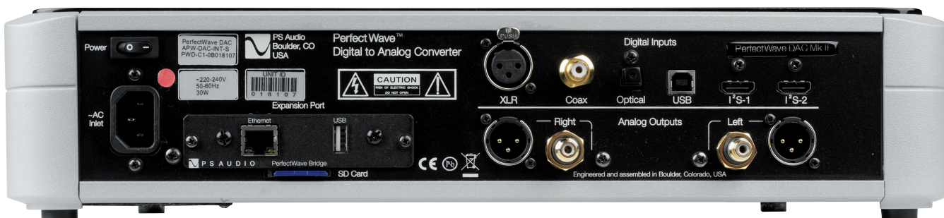
Alle digitalen Eingänge durchlaufen im der MKII-Version des Wandlers PS Audios exzellent funktionierende Jitter-Unterdrückung
