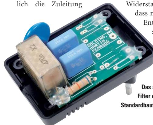
Das aufgeschraubte Isotek-Filter offenbart eine Handvoll Standardbauteile hoher Qualität
