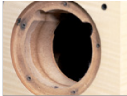
Passt genau: Chassis werden in der fünf Zentimeter dicken Schallwand versenkt
