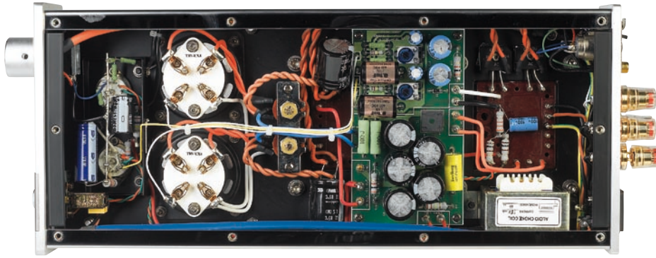
Teilweise auf Platine, teilweise frei verdrahtet - sehr sauber aufgebaut ist der Triodenverstärker allemal. Rechts unten gut zu sehen ist die Drossel des Netzteils. Die Endröhren sitzen in sehr hochwertigen Keramiksockeln, wie auch in allen Bereichen nur beste Bauteile eingesetzt werden
