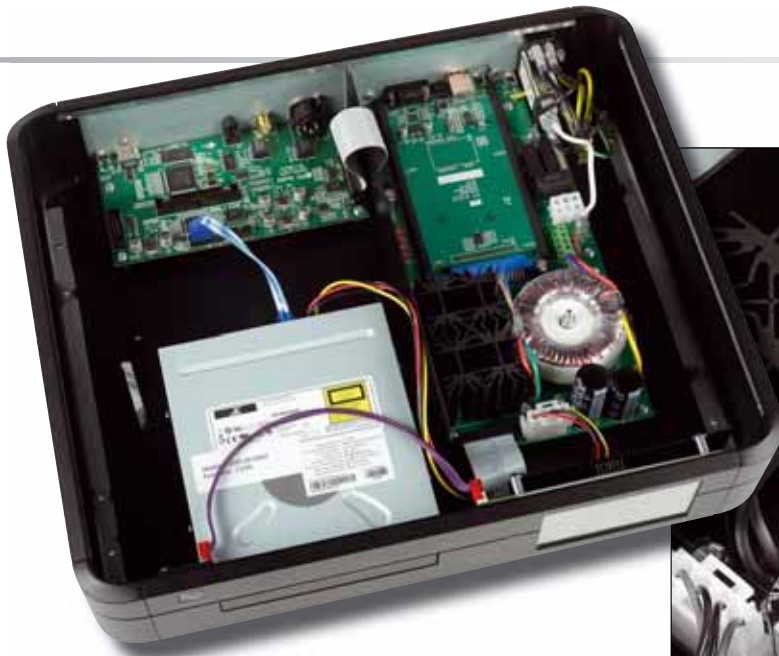
Auch im Inneren des PWTs geht's pragmatisch zu. Die Geheimnisse stecken in hochintegrierten Bausteinen. Abgesehen davon ist auch hier eine gute Stromversorgung die Basis von allem
